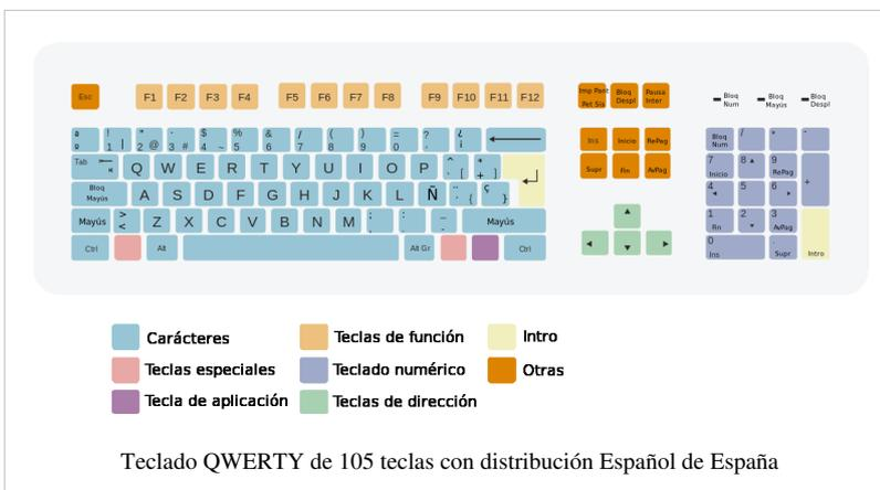
Un teclado <sup>[141]</sup> es un periférico de entrada o dispositivo, en parte inspirado en el teclado de las máquinas de escribir, que utiliza una disposición de botones o teclas, para que actúen como palancas mecánicas o interruptores electrónicos que envían información a la computadora.
