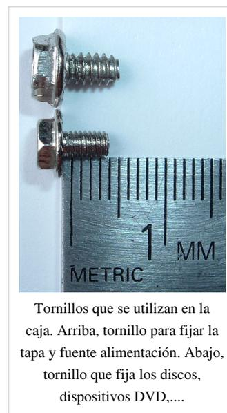
Tornillos que se utilizan en la caja. Arriba, tornillo para fijar la tapa y fuente alimentación. Abajo, tornillo que fija los discos, dispositivos DVD,....
