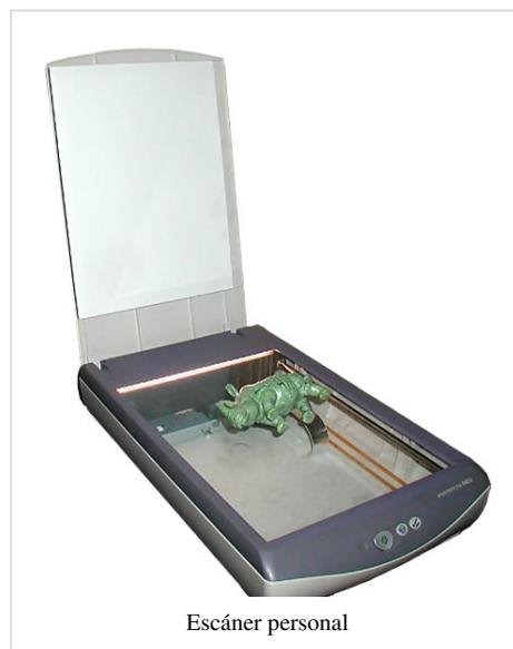
Otra de las características más relevantes de la calidad de un escáner es la **resolución, medida en píxeles por pulgada (ppp)**. Los fabricantes de escáneres en vez de referirse a la resolución óptica real del escáner, prefieren hacer referencia a la resolución interpolada, que es mucho mayor gracias a la interpolación software.
