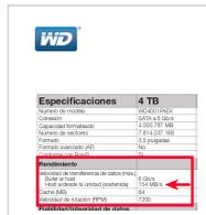
El fabricante WD no confunde. En las especificaciones técnicas indica claramente la velocidad de **transferencia sostenida** (154MB/s).
