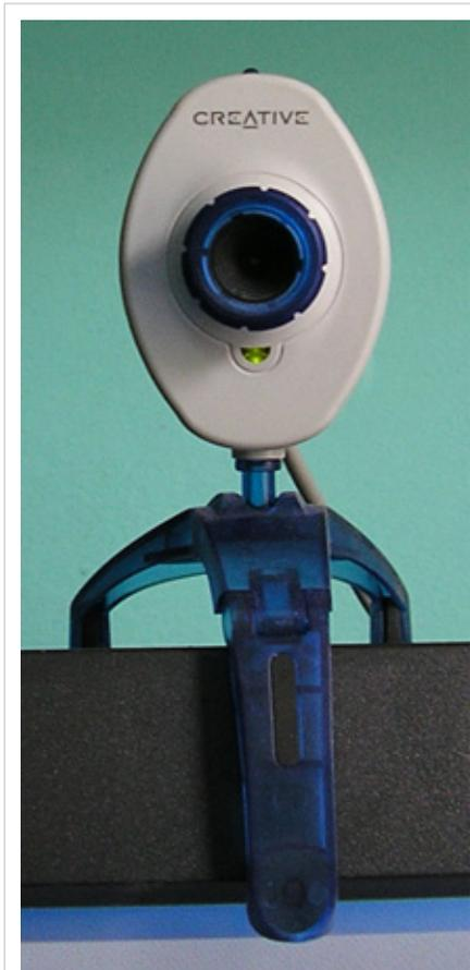
Cámara web sujeta al borde de la pantalla de una computadora portátil.
