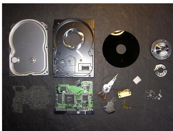
Componentes de un **disco duro**. De izquierda a derecha, fila superior: tapa, carcasa, plato, eje; fila inferior: espuma aislante, circuito impreso, cabezal de lectura / escritura, actuador e imán, tornillos.
