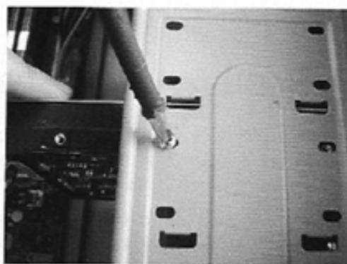
Fig. 6.34. Atomillado del disco duro.
