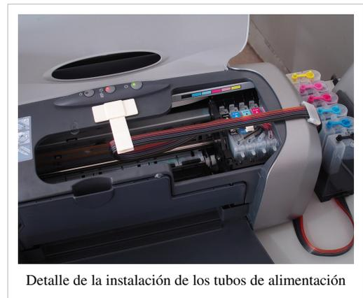
Detalle de la instalación de los tubos de alimentación
