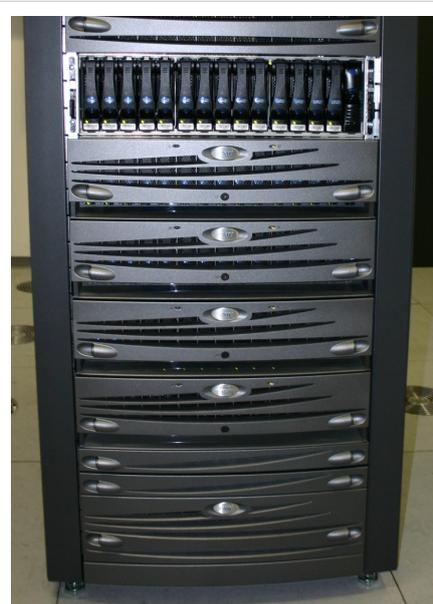
Muestra un Array de 15 discos. EMC Clariion CX500
