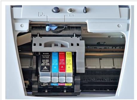
impresora inyección con la tapa abierta, muestra los cartuchos de impresión
