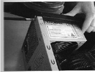
Fig. 6.27. Atornillamos la fuente de alimentación al chasis.
