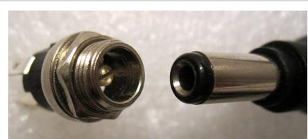
Detalle de la punta de un conector DC. La punta roja (D) la conectaríamos a la parte **metálica interna** del conector. La **punta negra (C)** a la parte **metálica externa** del conector.
