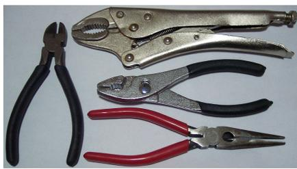
Cuatro tipos de pinzas de taller: pinza de corte (izq.), pinzas de presión (arriba), pinzas mecánicas (centro) y pinzas de punta (abajo).
