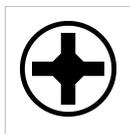
**Philips.** Muy utilizado, es el más común, en el montaje de equipos informáticos, generalmente en la unión de piezas. **Se suele confundir con el estrella** y se descabotan los tornillos.
