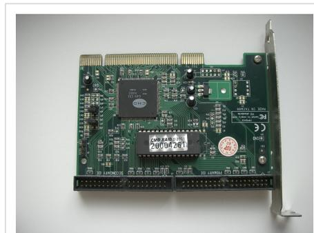
RAID hardware: tarjeta de expansión RAID
